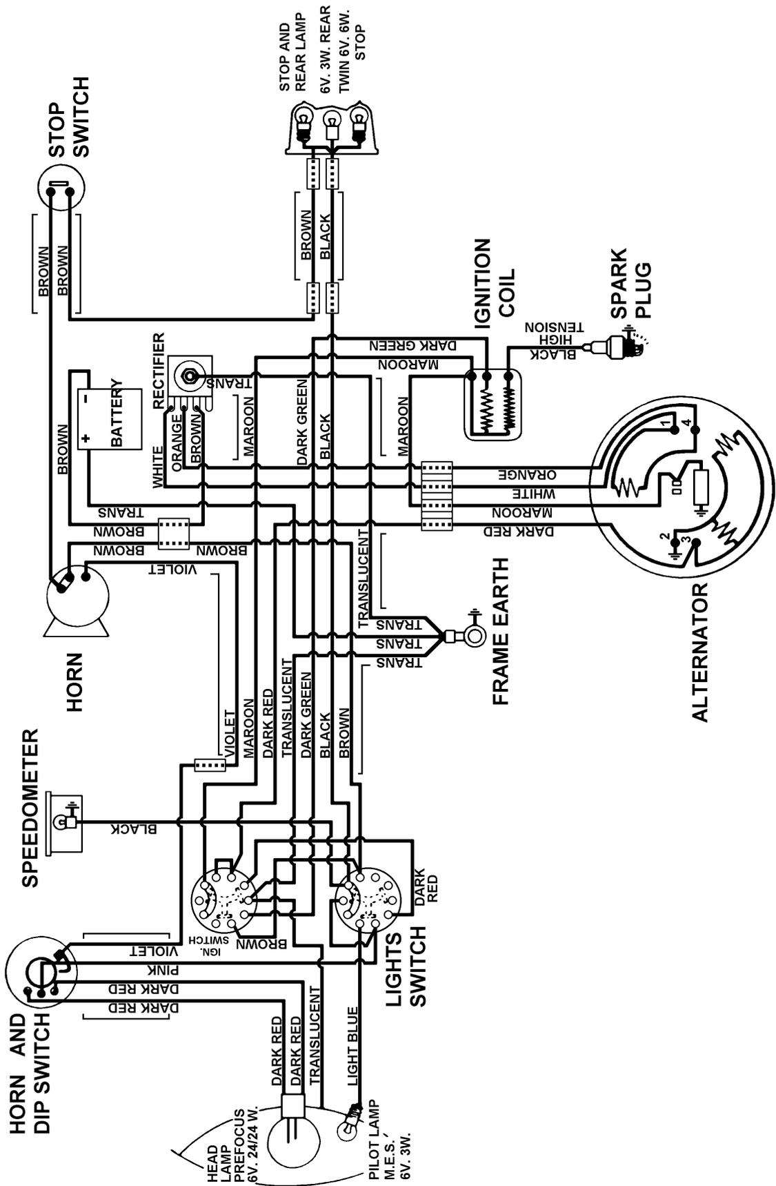
Fig. 9. Wiring Diagram
